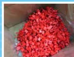
イワコーの消しゴムの材料は合成ゴム。色の付いたゴムの粒を溶かして、型に流し入れて固めることでいろんな形のパーツを作っています。パーツを作る様子を目の前で機械を動かして見せてくれるので、見逃さないようにしっかり観察してね★
